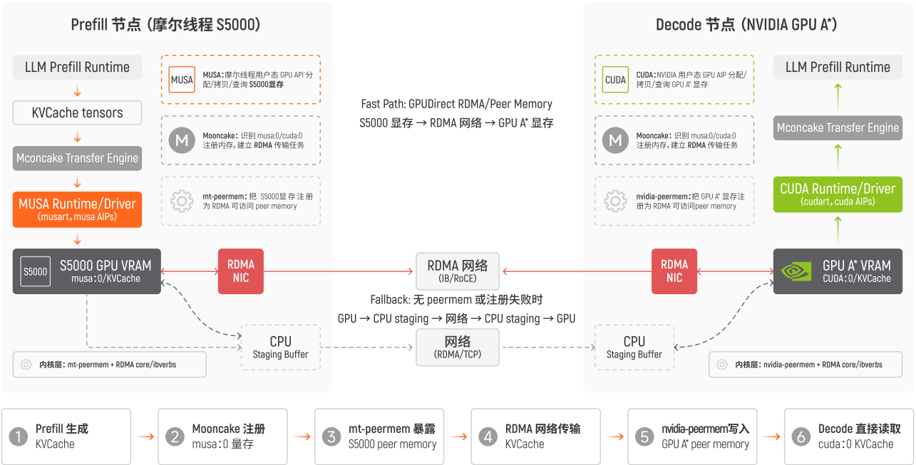
图 3-1 Mooncake 异构 KVCache 传输架构：Prefill S5000 (MUSA) → GPU A* (CUDA)
